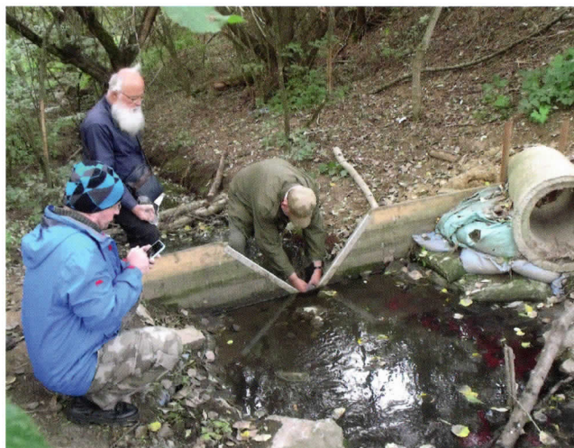
Foto 6 Měření průtoku Hostěnického potoka na Thompsonově přepadu nad Hostěnickým propadáním 1 (Foto J. Pokorný) Photo 6 Measurement of the discharge of the Hostěnický potok Stream using the Thomson weir upstream of Hostěnice Ponor 1 (Photo by K. Pokorný)
