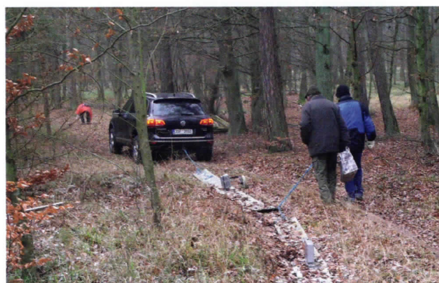
Foto 4 Georadarové měření dne 6. 12. 2019 – vůz konstruktéra georadaru Ing. Tenglera táhne elektrody georadaru po vyznačené trase (Foto J. Pokorný 2019)
